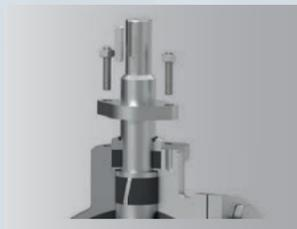
Die **Wellenabdichtung** besteht aus einer Graphit-Packung in Kombination mit einem EPDM O-Ring.
