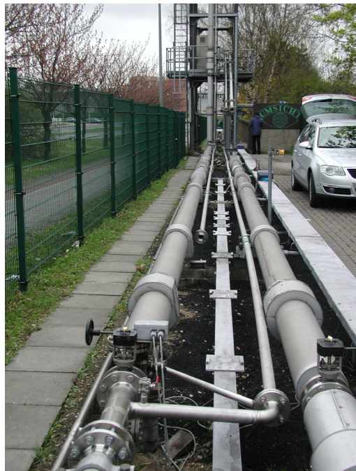
Bild 11: Stichleitung zur Verdopplung des Druckstoßes [7]
