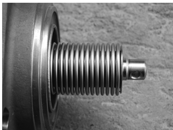
Bild 17: Faltenbalg des FABA®-Supra-C PN 40 nach Druckstößen von 200 bar
