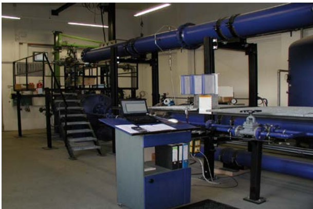
Abb. 5 und 6: Leistungsprüfstand (Luft) der Albert Richter ARI-Armaturen GmbH & Co. KG
