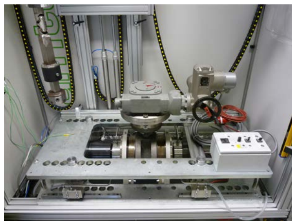
Abb. 1: Amtec-Prüfbericht Nr.: 302 586 2/- Beilage 16 – Prüfungsverlauf und Ergebnisse EN 15848-1 [3] [5]
